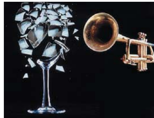
16.20 La frecuencia del sonido de esta trompeta coincide exactamente con una de las frecuencias de modo normal de la copa. Las vibraciones resonantes de la copa tienen una amplitud tan grande que el cristal se hace añicos.
